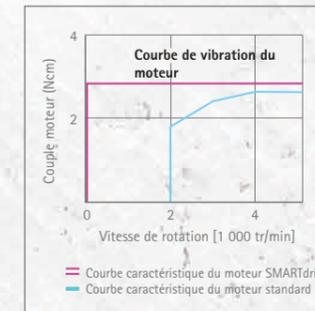
Profitez de la grande puissance d'entraînement et du comportement au démarrage exempt de vibration de votre KaVo SMARTdrive avec une plage de vitesse élargie de 100 à 40 000 tr/min.
