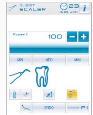
En plus de la visualisation des données, plusieurs réglages de travail sont possibles : les sprays, les modes de la pédale de commande, l'allumage et l'extinction des fibres optiques. Jusqu'à quatre opérateurs peuvent personnaliser de nombreux paramètres via la console.
