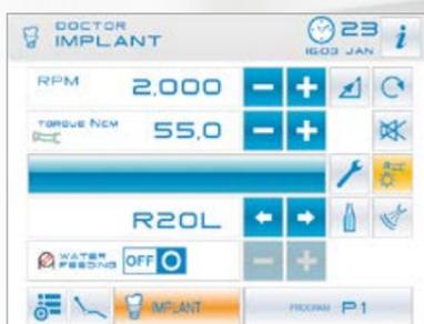
La commande électronique des fonctions du micromoteur i-XS4 comprend la vitesse, le couple et, quant à la pompe péristaltique, le débit et le fonctionnement. Il est possible de personnaliser les réglages pour la réalisation du trou de guidage, de l'alésage et pour la pose de l'implant.
