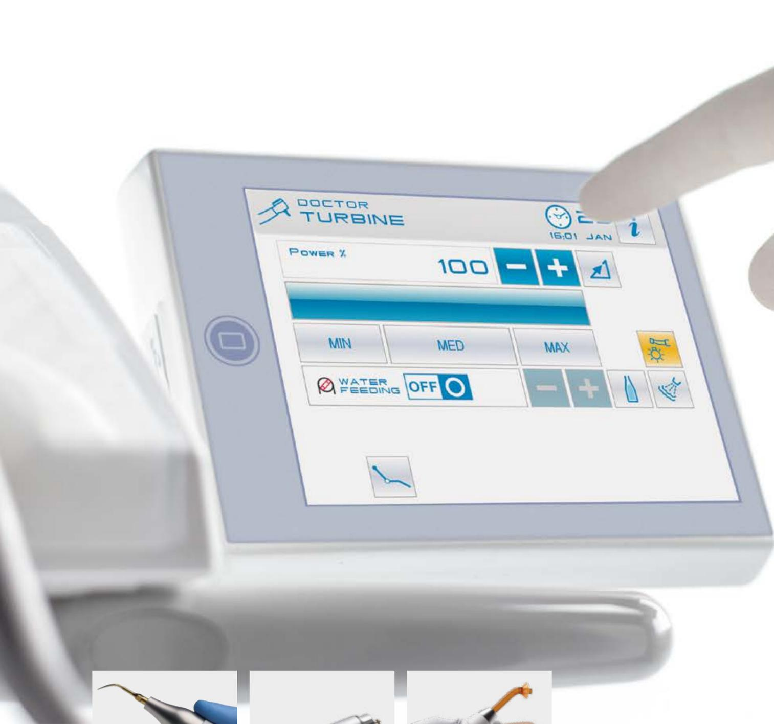
L'opérateur peut non seulement régler des programmes personnalisés, mais aussi modifier la puissance du détartreur et les paramètres de travail concernant le spray, le mode pédale de commande et l'intensité des fibres optiques
